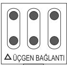
Not: 220V AC beslemeli cihazlarda motor bağlantısı üçgen yapılmalıdır.
